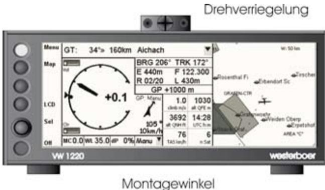
Die Standardanordnung der Montagewinkel ist in nachfolgender Abbildung dargestellt. Durch die Drehverriegelung ist es mit wenigen Handgriffen möglich das Display aus dem Cockpit herauszunehmen.
