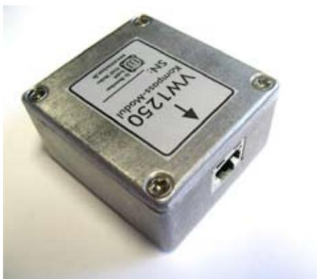
Da ein Segelflugzeug sich nicht nur in einer horizontalen Ebene bewegt, wird durch eine ausgeklügelte Technik die Messung des VW1250 nur gestartet, wenn Quer- und Längsneigung in einem definierten Bereich liegen. Der Anwender merkt von alledem nicht viel.
